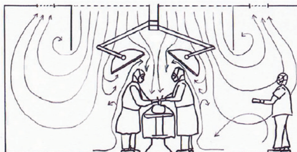
Abbildung 2: Fast unwirksame Verdrängungslüftung infolge übergrosser OP-Leuchten und Umlufffassungen nahe des TAV-Feldes in der Decke.
