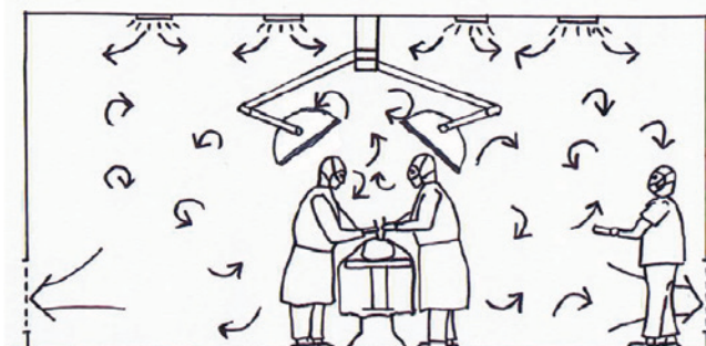
Abbildung 3: Mischlüftung mit überall gleicher Mischluftqualität.
